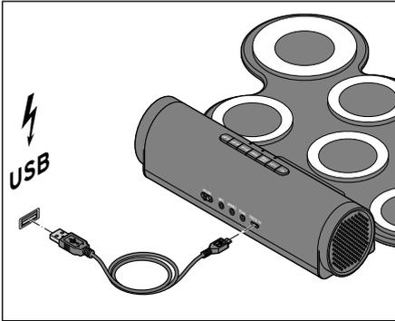
1. Verbinden Sie den Micro-USB-Stecker des USB-Kabels mit der Anschlussbuchse **USB/DC5V** des Gerätes und den USB-A-Stecker mit dem USB-Netzadapter.
