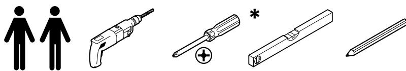
\* **VORSICHT:** Bei Verwendung eines Akkuschraubers (nicht empfohlen) möglichst niedrige Drehmomentstufe wählen!
